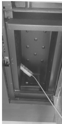
**Fig. 36 - Nettoyage avec nettoie-pipes**
