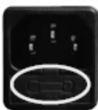
Fig. 81 - Hublot avec les fusibles à enlever
