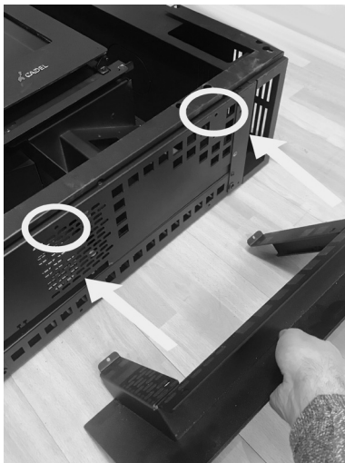
Fig. 59 - Mettre le piédestal en place
