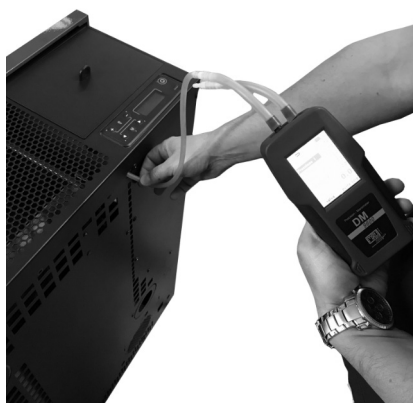
Fig. 71 - Raccordement du pressostat numérique
