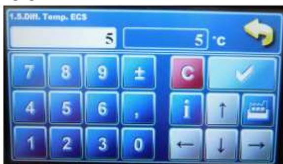
7- Le menu « 1.5.Diff. Temp. ECS » est la différence de température à laquelle la pompe d'alimentation du préparateur ECS réalimentera celui-ci. Ici, elle est réglée à 5°C, soit un redémarrage à 45°C (50-5). Fig. g
