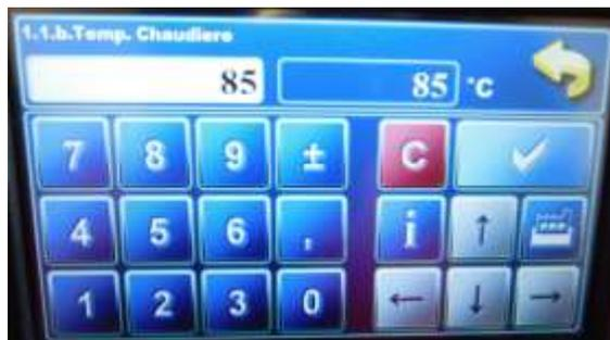
3- Le menu « 1.1.b.Temp. Chaudière » est la température maxi de la chaudière en mode bois. Sur l'illustration, elle est réglée à 85°C. Fig. c
