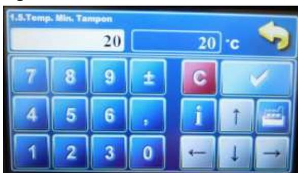
8- Le menu « 1.5.Temp. Mini Tampon » est la température à laquelle les pompes des circuits de chauffage pourront être activés. Ici, elle est réglée à 20°C. Fig. h
