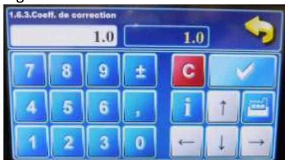
5- Sur le menu « 1.6.3.Coeff. de correction », vous pouvez changer le degré de correction. Ici le coefficient est réglé à 1. Sur le correcteur d'ambiance - CSK, chaque graduation correspondra approximativement à 1°C. Fig. e
