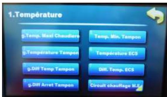
3- Selon vos besoins, vous pourrez paramétrer la température du ballon tampon et la température de l'ECS. Fig. c
