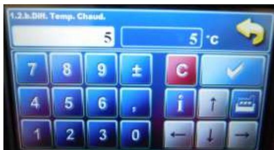
4- Le menu « 1.2.b.Diff. Temp. Chaud. » est le delta de température de redémarrage de la chaudière. Fig. d
