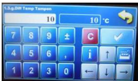
6- Le menu « 1.3.g.Diff Temp Tampon » est la différence de température à laquelle la chaudière granulés redémarre la combustion. Ici, elle est réglée à 10°C soit un redémarrage à 70°C (80-10) et est calculée sur la température haute du ballon tampon. Fig. f
