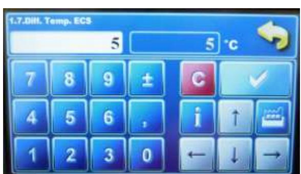
10- Le menu « 1.7.Diff. Temp. ECS » est la différence de température à laquelle la pompe d'alimentation du préparateur ECS démarre. Ici, elle est réglée à 5°C soit un démarrage à 45°C (50-5). Fig. j
