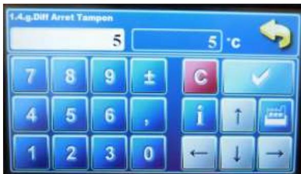
7- Le menu « 1.4.g.Diff. Arret Tampon » est la différence de température sur la sonde basse à laquelle la chaudière granulés arrête la combustion. Ici, elle est réglée à 5°C soit un redémarrage à 75°C (80-5) et est calculée sur la température haute du ballon tampon. Fig. g
