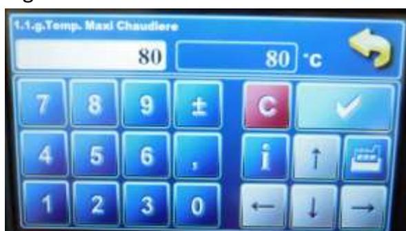
4- Le menu « 1.1.g.Temp. Maxi Chaudière » est la température maxi de la chaudière en mode granulés. Sur l'illustration, elle est réglée à 80°C. Fig. d
