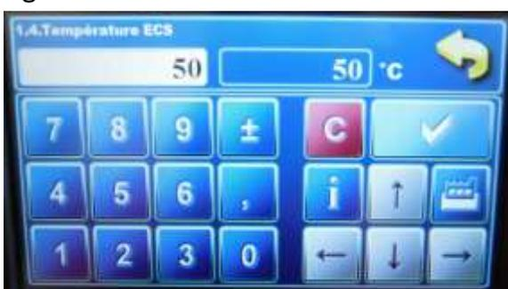
6- Le menu « 1.4.Température ECS » est la température du préparateur ECS. Sur l'illustration, elle est réglée à 50°C de consigne. Fig. f
