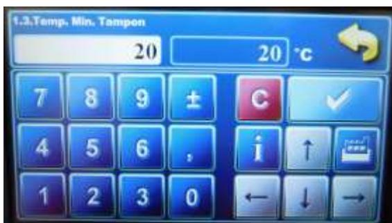
5- Le menu « 1.3.Temp. Mini Tampon » est la température à laquelle les pompes des circuits de chauffage pourront être activés. Ici, elle est réglée à 40°C. Fig. e
