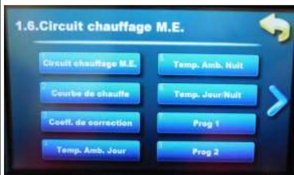
2- Sur le menu « 1.6.Circuit chauffage M.E. », appuyer à nouveau sur « Circuit chauffage M.E. ». Fig. b
