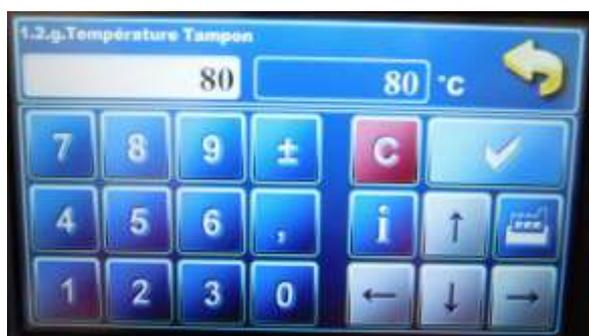
5- Le menu « 1.2.g.Température Tampon » est la température maxi du ballon tampon. Sur l'illustration, elle est réglée à 80°C. Fig. e
