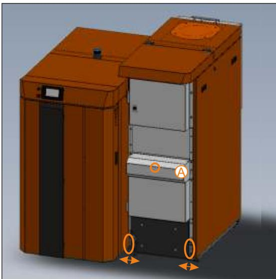
La partie droite de la chaudière dispose d'un capot réglable. Le capot est fixé au moyen de vis. Afin de pouvoir l'aligner sur le capot gauche de la chaudière, dévisser les vis. (N.B.: le capot peut être réglé uniquement de la gauche vers la droite).
