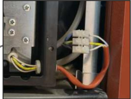
2. Dévissez les 4 vis et déposez le volet d'air primaire. Dévissez ensuite les 2 vis du support du réchauffeur et sortez le support avec l'élément d'allumage.
