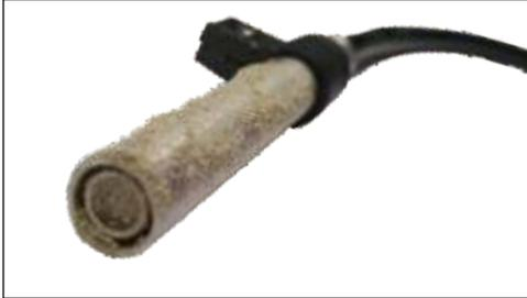
Cellule photoélectrique encrassée pouvant entraîner une erreur d'allumage ou une erreur d'extinction de flamme
