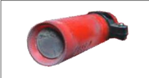
Cellule photoélectrique encrassée pouvant entraîner une erreur d'allumage ou une erreur d'extinction de flamme
