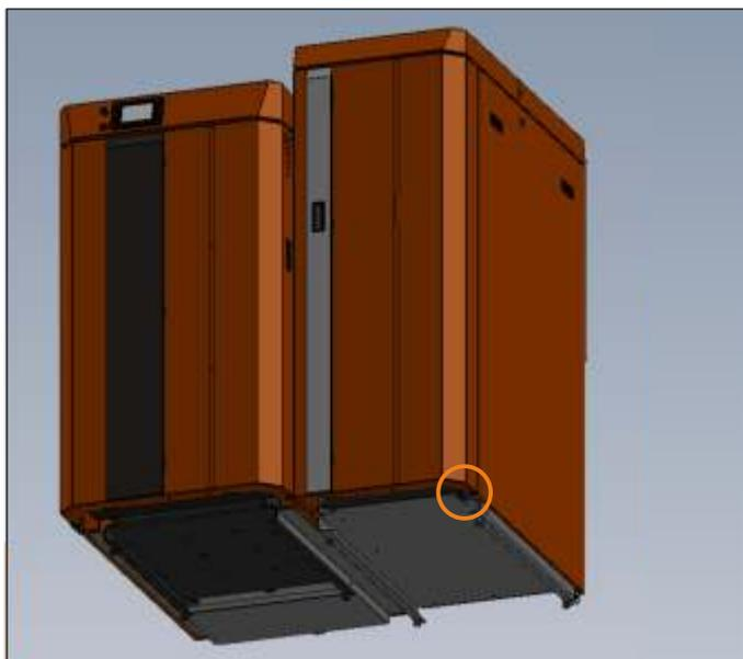
Le capot avant de la partie droite de la chaudière peut être réglé au moyen de la vis de réglage inférieure afin de l'aligner avec les autres capots.
