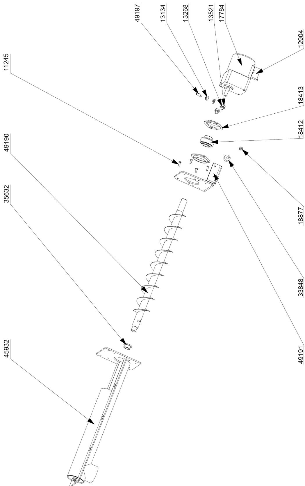
VUE ÉCLATÉE DE LA CHAUDIÈRE GMX EASY 35 - côté - GRANULÉS - vanne rotative de l'alimentation en granulés
