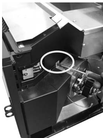
Fig. 66 - Retirer la vis 1
