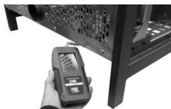
Fig. 58 - Connexion du pressostat numérique Frame 3
