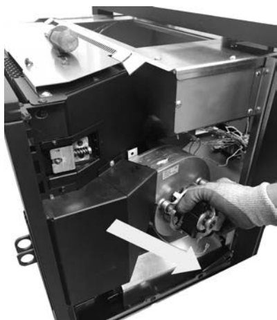
Fig. 68 - Retirer le ventilateur
