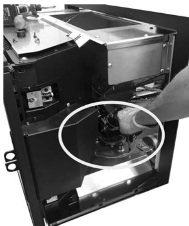
Fig. 69 - Retirer les vis
