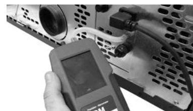
Fig. 59 - Connexion du pressostat numérique Modo At et Quasimodo 3 Up
