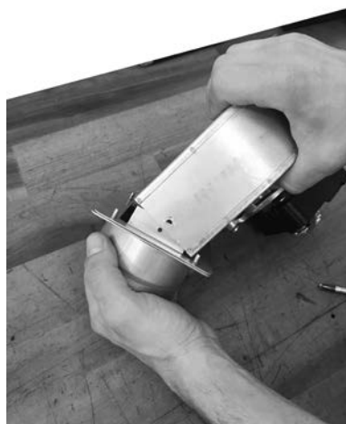
Fig. 38 - Fixer la bride + le raccord au ventilateur
