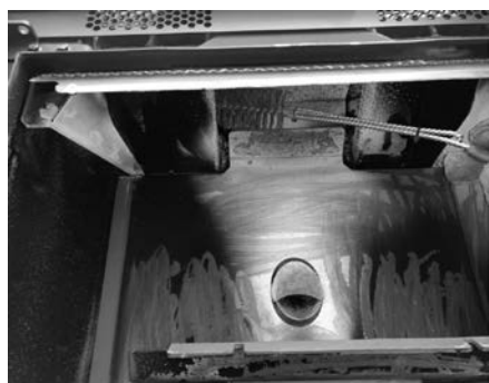
Fig. 78 - Nettoyer avec un goupillon.
