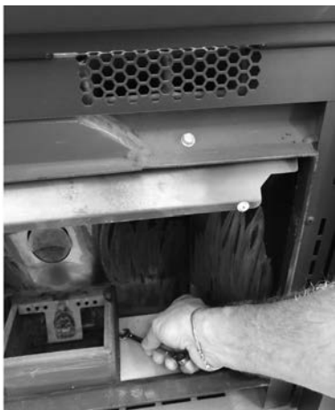
Fig. 74 - Retirer les vis
