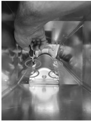
Fig. 60 - Retrait des vis
