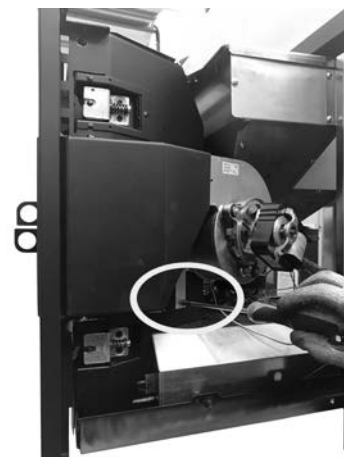
Fig. 67 - Retirer la vis 2
