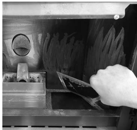
Fig. 75 - Retirer le bouchon d'inspection
