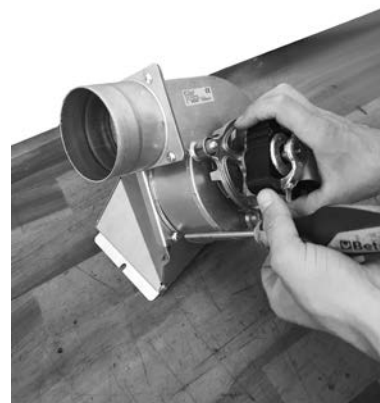
Fig. 42 - Fixer avec des vis
