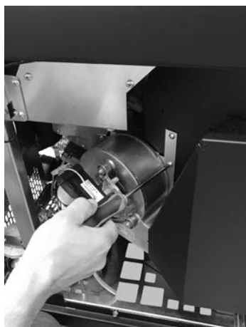
Fig. 35 - Retirer les vis
