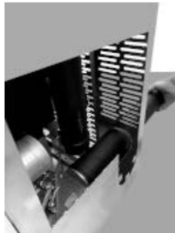
*Fig. 105 - Raccorder le tuyau de canalisation*
