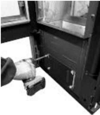
*Fig. 134 - Retirer le bouchon*
