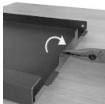
**Fig. 47 - Plier les languettes vers l'extérieur**
