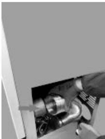
*Fig. 106 - Détacher le tuyau flexible*
