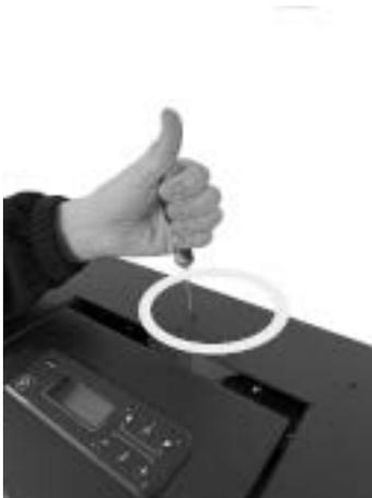
Fig. 77 - Retirer le bouchon (Saba 14).
