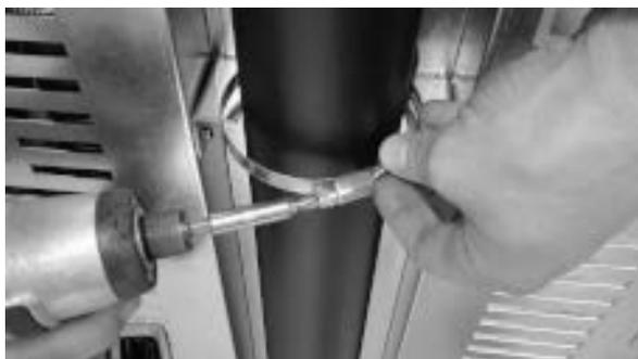
*Fig. 86 - Bloquer avec un collier de serrage*
