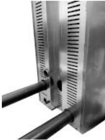
*Fig. 88 - Sortie d'air chaud sur l'arrière*
