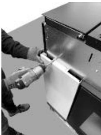
**Fig. 48 - Fixer les panneaux latéraux**
