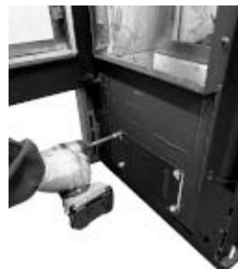
Fig. 122 - Retirer le bouchon
