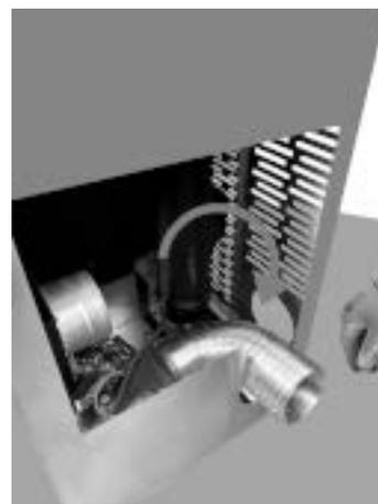
*Fig. 100 - Tourner le tuyau flexible*
