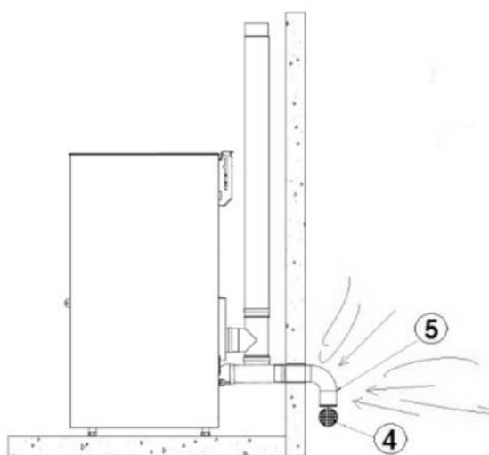
Fig. 9 - Prise d'air pour installation en chambre étanche
