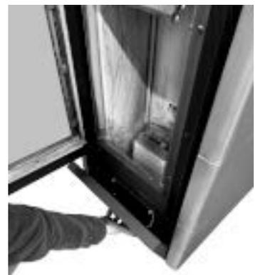
*Fig. 35 - Décrocher le panneau inférieur.*
