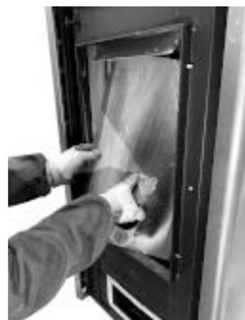
*Fig. 131 - Retirer le panneau arrière du foyer*
