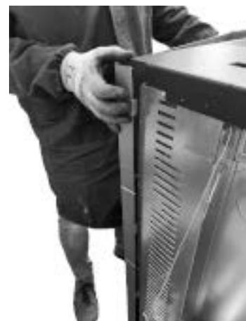
*Fig. 37 - Décrocher le flanc*
