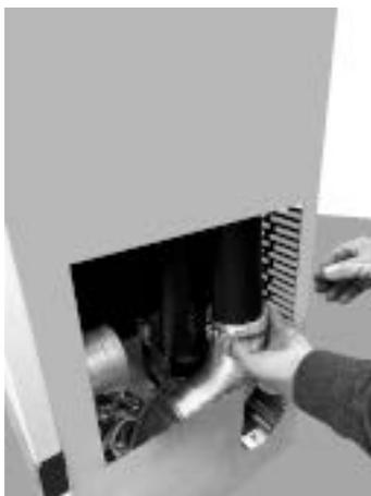
*Fig. 110 - Raccorder les tuyaux*
