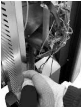
*Fig. 138 - Nettoyage de le ventilateur ambiant*
