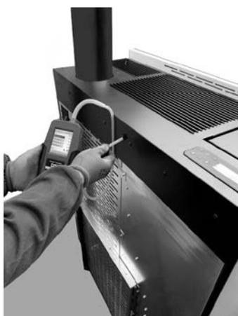
**Fig. 118 - Connexion du pressostat numérique (Mithos³ Plus12/14)**
