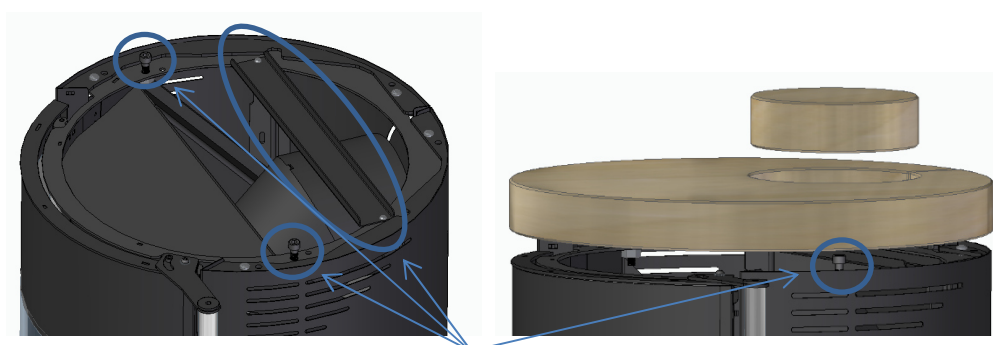
Figure 14 - Pose du dessus en pierre dans l'équipement avec sortie de fumée horizontale
