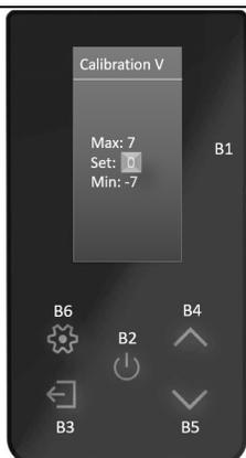
Accès au menu de Combustion - Calibration Moteur sans fin
