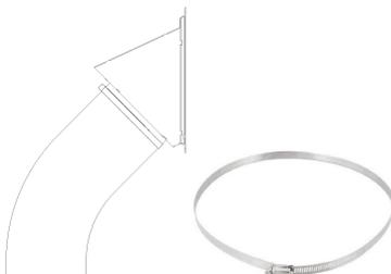
**Figure 14 - Installation de la bouche et collier métallique.**
