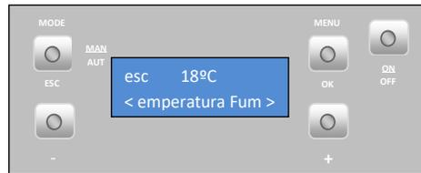
En appuyant encore sur le bouton « + » on passe à « temps vis », durée (« on ») d'alimentation électrique de la vis sans fin.
