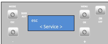
En appuyant encore sur le bouton « + » on passe à « activation », qui indiquera l'état de l'appareil (on ou off).
