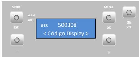
Code paramètres. En appuyant encore sur le bouton « + » on passe à « heures de fonctionnement ».
