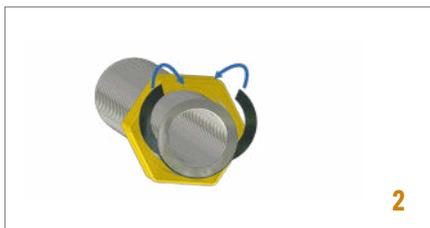
Tirer l'écrou jusqu'à ce qu'il vienne en butée de la bague, y insérer 1 ou 2 joints fibres haute température, raccorder le tuyau en faisant tourner l'écrou libre.
