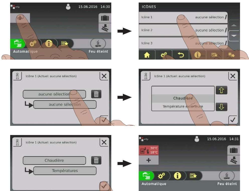
En cas d'utilisation de plus de deux sondes d'accumulateur, un affichage d'informations est possible avec les températures d'accumulateur conformément au nombre de sondes. L'illustration a lieu via un affichage d'informations déroulant sur deux surfaces.
