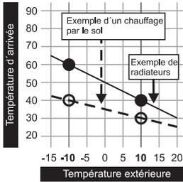
Via la courbe de chauffage du circuit de chauffage, en fonction de la température extérieure et avec les deux paramètres réglables « température de départ avec température extérieure de  $-10\text{ °C}$  » et « température de départ avec température extérieure de  $+10\text{ °C}$  », une température de départ est calculée.
