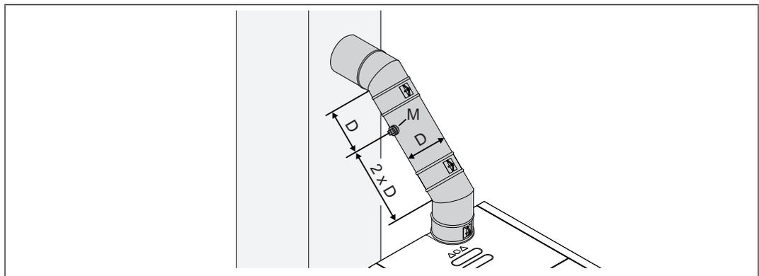
En amont de l'ouverture de mesure (M), prévoir un tronçon d'arrivée droit à une distance correspondant environ au double du diamètre (D) du conduit de raccordement. En aval de l'ouverture de mesure, prévoir un tronçon de sortie droit à une distance correspondant à environ une fois le diamètre du conduit de raccordement. L'ouverture de mesure doit rester fermée en permanence durant le fonctionnement de l'installation.
