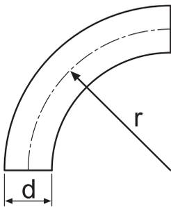
Le rapport entre le rayon de courbure (r) et le diamètre du tuyau (d) doit être supérieur à 1
