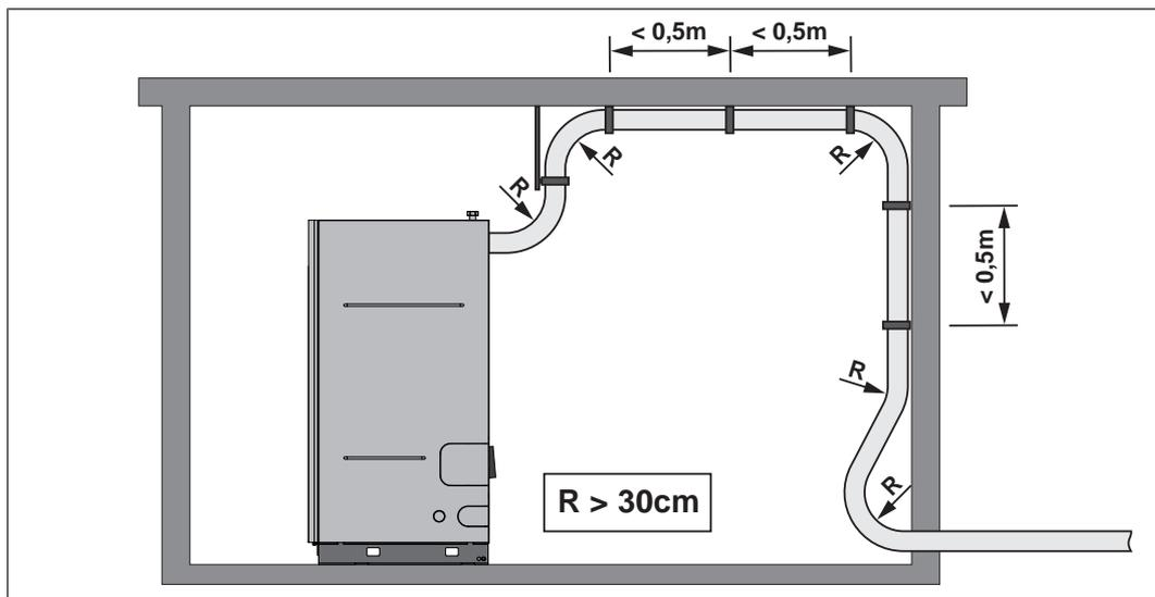
Respecter les instructions suivantes pour les flexibles utilisés dans les systèmes d'extraction par aspiration Froling :
