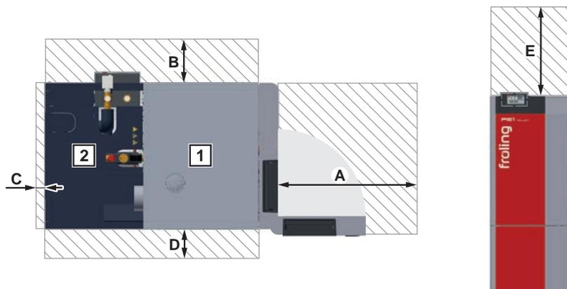
1 ... Chaudière à granulés PE1 Pellet Unit | 2 ... Échangeur de chaleur à condensation
